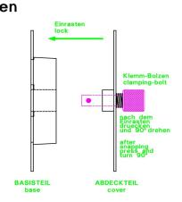
GESCHLOSSEN closed bereit zum KABEL wickeln ready to wind the cable
